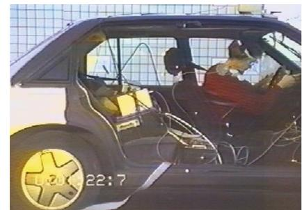
**BILD 2:** Sekundärbewegung der Insassen
